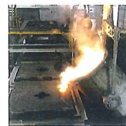
マンホール鉄蓋の製造工程 (提供 虹技株式会社)
